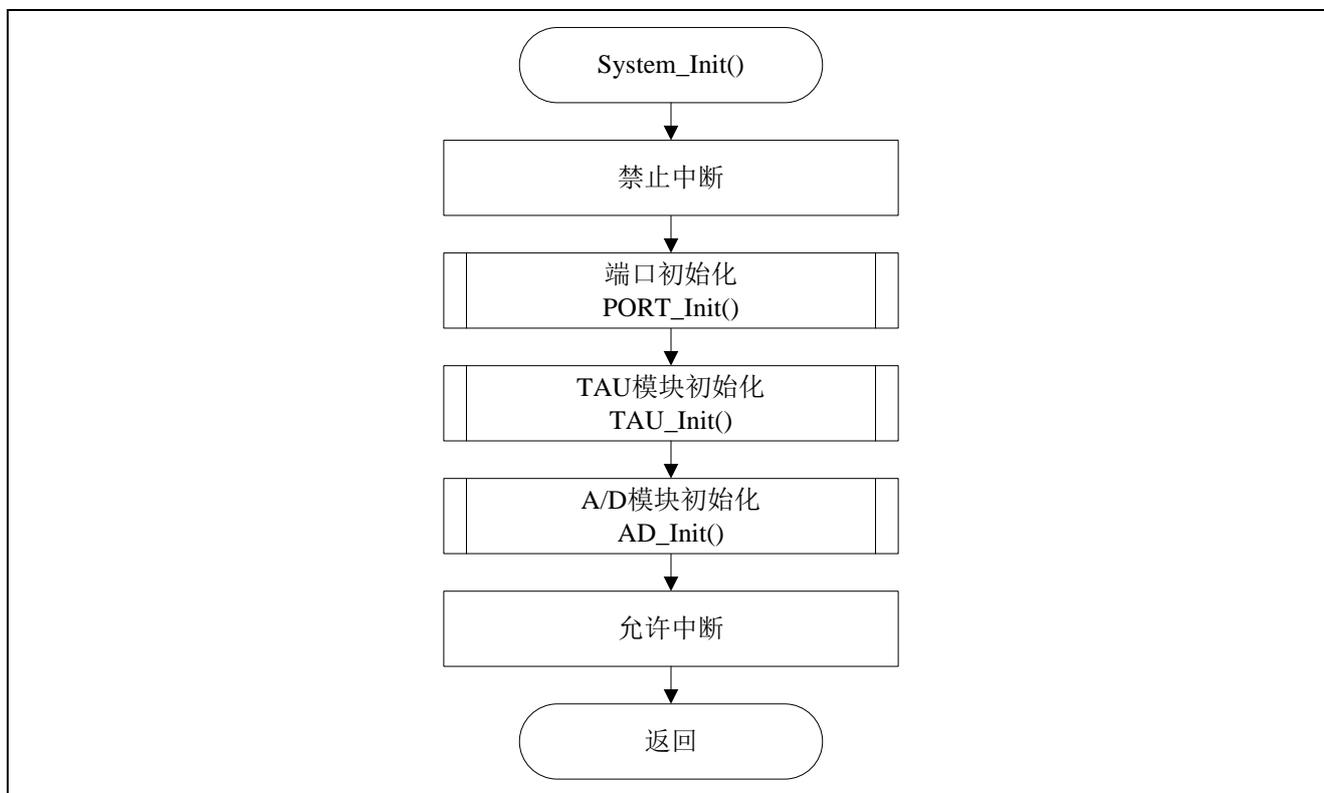
图 5.3 系统初始化函数
